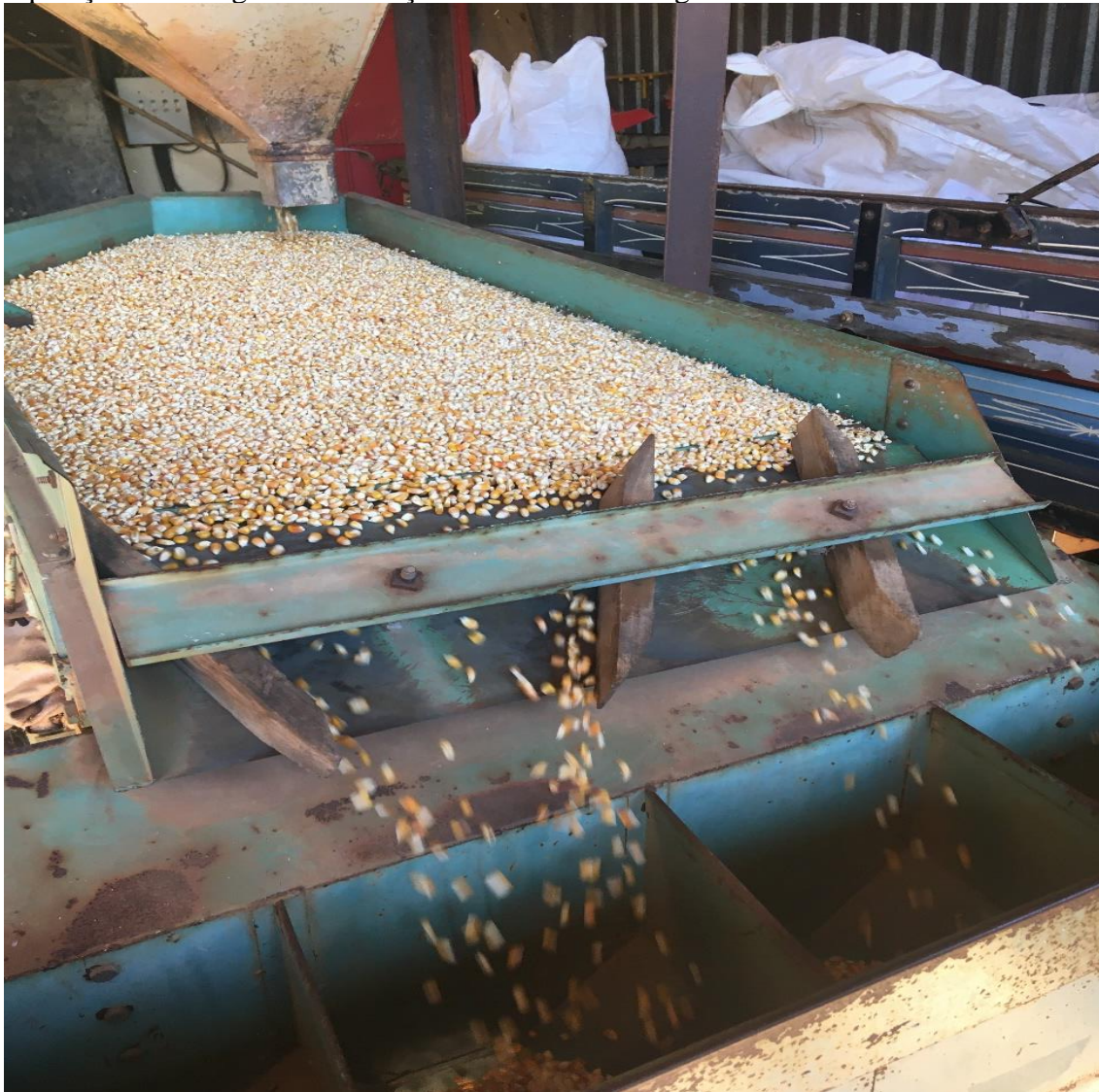
Figura 1 - Mesa densimétrica utilizada para beneficiamento e saídas utilizadas para separação das categorias em função da densidade dos grãos de milho.
